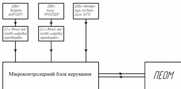
Рисунок 12.7 – Схема підключення датчиків витрати, тиску та температури через мікроконтролерний блок керування до комп'ютера
