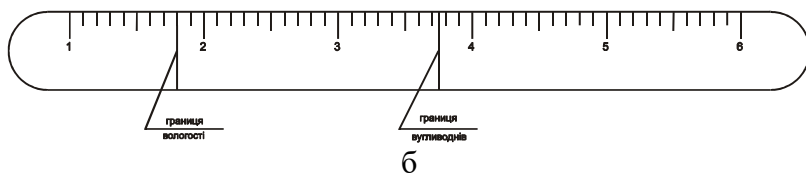
Рисунок 8.1 – Структурна схема індикатора кондиційності газів „Харків-1М” (а) та схема розташування границь випадання вологи і вуглеводнів на конденсаційній дзеркальній поверхні приладу (б)
