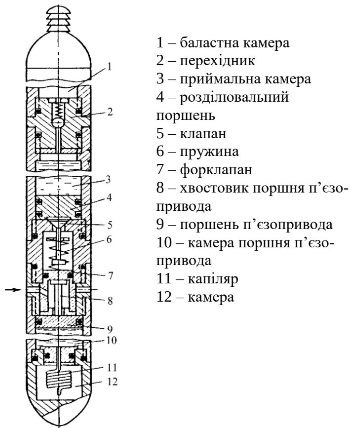
Рисунок 12.2 – Принципова схема глибинного пробовідбірника з непротічною камерою ВНИИ-1
