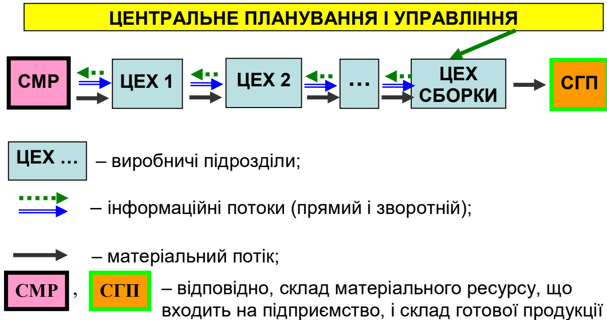
Рис. 2.6. Схема тягнучої системи управління матеріальними потоками
