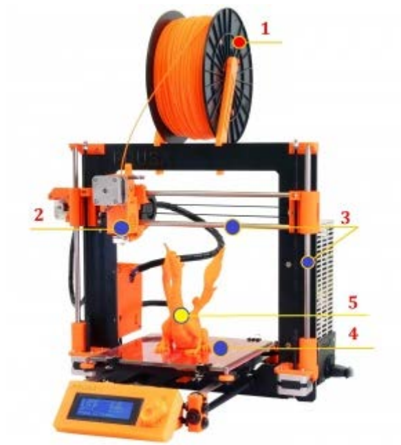
Рис. 1.2 – Принцип роботи 3Д принтера FDM типу
